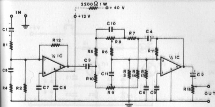
Il preamplificatore RS 51 è stato appositamente studiato per funzionare con l'amplificatore RS 36. L'alimentazione prevista è di 12 V ed il suo assorbimento è di soli 12 mA. Se si desidera alimentarlo con la stessa tensione dell'RS 36 (40 V) occorre mettere in serie all'alimentazione una resistenza da 2.200 ohm 1 W, come indicato in figura.
